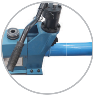
Ranhure o tubo. Procedimento feito com a máquina de ranhurar
