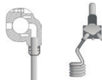
Aperte os parafusos para completar a instalação
